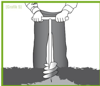
Punktfundamente einmessen (auf Grenzverlauf achten), z.B. mit Erdbohrer ausheben oder mit Spaten rechteckig abstechen. Die Fundamentgröße richtet sich nach den örtlichen Gegebenheiten und muss den statischen Erfordernissen entsprechend objektbezogen eigenverantwortlich bestimmt werden.
