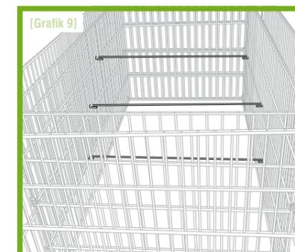
Hängen Sie nun die inneren Verbindungs-Abstandhalter [Grafik 4] zur Aussteifung gleichmäßig verteilt in den Innenbereich. Je nach Variante (60/80) 6 bzw. 8 Stück. Die T-Abstandhalter werden mittig untereinander angeordnet. Die Folie wird dabei durchgestoßen. Anschließend das Hochbeet im rechten Winkel ausrichten (innere Diagonale 250 cm) und die Universalklemmen fest anziehen.
