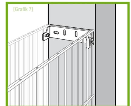
Wandanschluss einmessen und Bohrlöcher (mindestens 2 Befestigungspunkte erforderlich) am Befestigungsgrund (z.B. Mauerwerk, Beton etc.) anzeichnen. Die Anordnung (Anzahl) der Wandanschlüsse richtet sich je nach Höhe der Rankgittermatten nach der Anzahl der Universalklemmen [Grafik 7].
