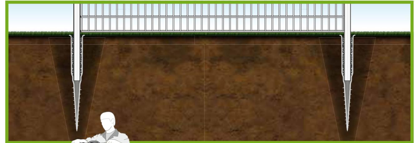
Sie wollen ja einen Zaun, und keine Löcher im Garten. Deshalb haben wir für Sie den PERGONENZAUN mit dem einzigartigen Krinner-Schraubfundament entwickelt: Schraubfundament eindrehen, Pergonenzaunsäulen einsetzen und ausrichten, Granulat einfüllen – fertig.
