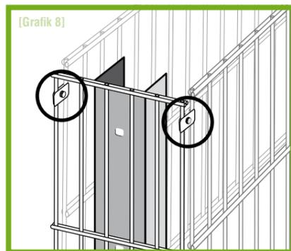
Vor dem Anbringen der Rankgittermatten muss der Fundamentbeton ausgehärtet sein! Die Rankgittermatten müssen mit dem Boden abschließen. Die Befestigung erfolgt mittels Universalklemmen [Grafik 11]. Die Rankgittermatten werden mittels dieser Universalklemmen fixiert (Handfest anziehen).
